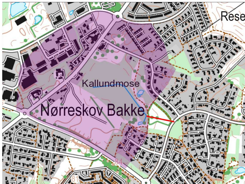
Figur 3. Oplandskort med det topografiske afstrømningsopland til afløbet fra Kallund Mose vist fremhævet med lilla farvetone sammen med det rørlagte afløb i rød streg på baggrund af Kort25, SDFI© i skala 1:10.000.
